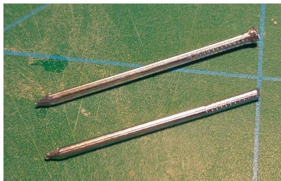
**3.** Når hodet er kappet av setter du spikeren i drillen med spissen ut. Mens drillen roterer filer du spissen litt rundere. Ikke kjør drillen raskere enn maks på hastighet 1, hvis du har to hastigheter/gir på drillen. Begynn med ei grov fil og avslutt med ei fin fil. Avslutt med å avrunde den ytterste delen av spissen så den ikke er for skarp.
